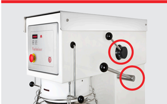
VL-1 – Ручное регулирование скорости и ручное опускание дежи
